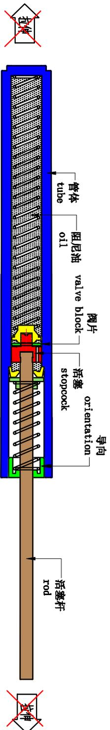
主动返回缓冲器内部结构示意图
